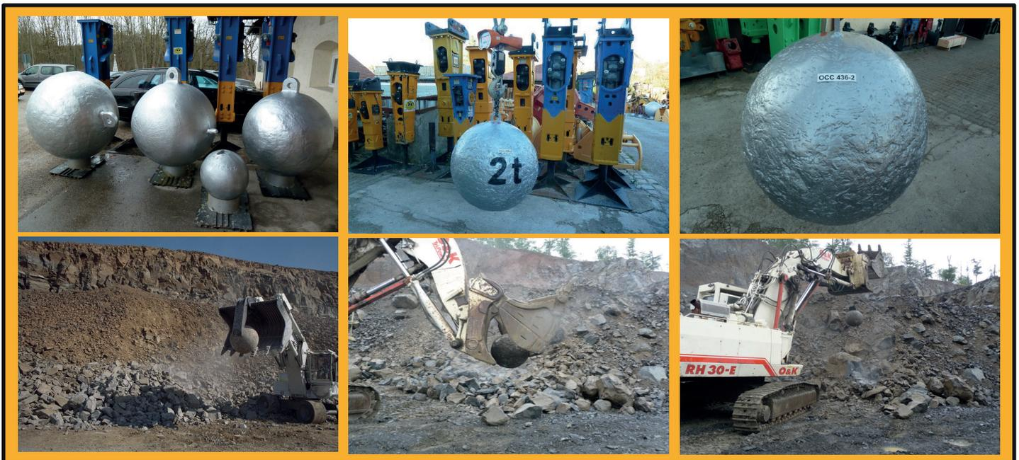
Wird aus SAT-eigenen Kugelmodellen gegossen, nach Abguss und Fertigstellung wird die Kugel gewogen und das tatsächliche Gewicht berechnet. Jedes Kugelmodell wird mit einer eingeschlagenen SAT ID - Kennzeichnung ausgeliefert.
