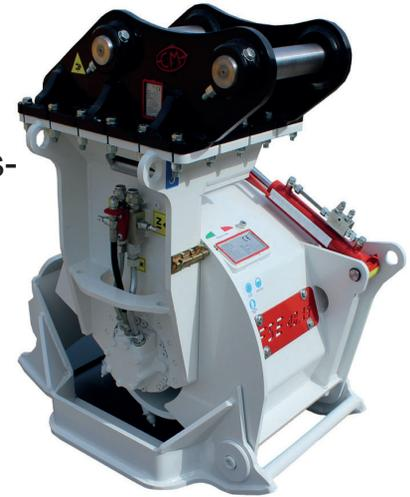
**Konstante Frästiefe**, dank der Schwenkvorrichtung auf derselben Drehachse der Frästrommel behält das Gerät eine perfekte Schnittfläche in jeder Bedingung bei, - unabhängig vom Bodenprofil und der Lage des Geräts gegenüber des Antriebsfahrzeugs. Der Schwenkarm, der in der Drehachse der Frästrommel sitzt, gleicht Bewegungen des Trägergerätes oder Unebenheiten des Bodens aus. Dadurch liegen die Gleitkufen immer gleichmäßig auf dem Boden und schaffen somit eine konstante Frästiefe.
