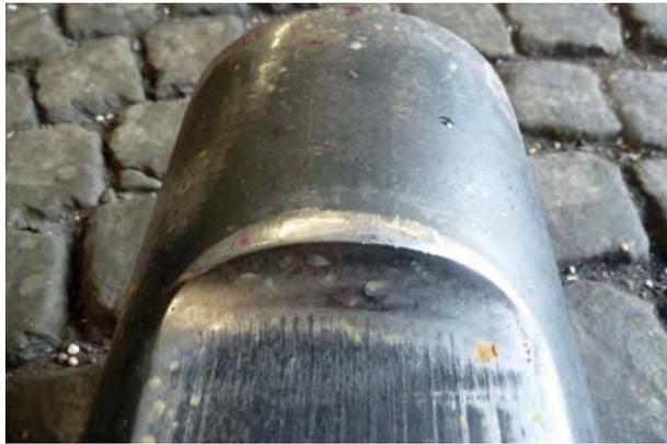
von der Sperrachse / Haltekeil aufgestauchter Bord (Haltenut), muss entgraten werden!
