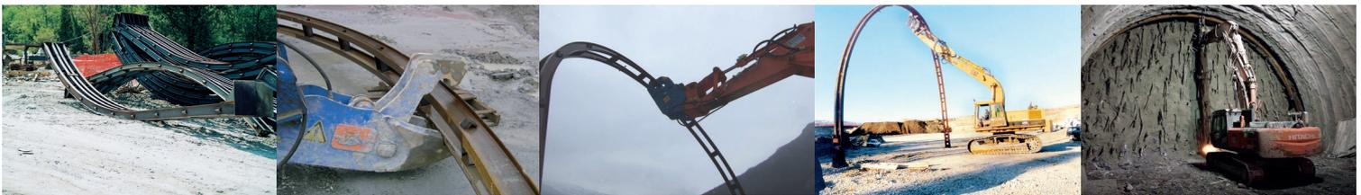
Die GPZ ist eine Greif- u. Positionierzange, eine hydraulische Klammer zur Positionierung der Rippen, die die Bögen bilden die Tunnel und Galerien stützen. Jedes Modell wird entsprechend den Merkmalen, Abmessungen und Stärken der Rippe oder des zu hebenden Balkens „nach Maß“ konstruiert und gebaut.
