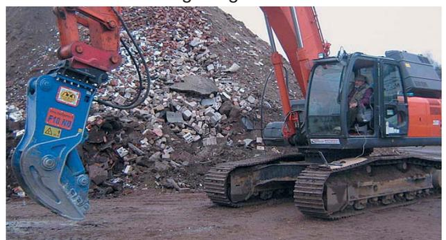
Der **PU F20R** dient vorrangig für den Recyclingeinsatz und kann durch die Drehung auch ins Haufwerk hineinarbeiten. Er ist außerdem für den Primärabbruch einsetzbar.
