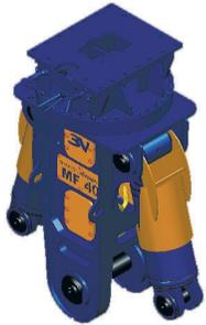
Das auswechselbare Unterteil (UT) in der Ausführung als **Tankscheren** für die **MF** Multi-Funktionszange Serie **MF**, ist primär geeignet zum Tankabbruch und zum Knäppern von Eisen-/Blechteilen.
